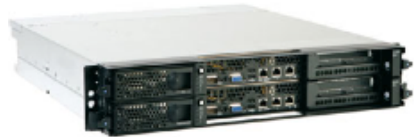
Exemple : Nœud de calcul dx360-M3 (ancienne solution IBM iDataPlex)
